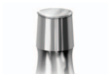
図5 先端が押しつぶされた テーパートラニオン
